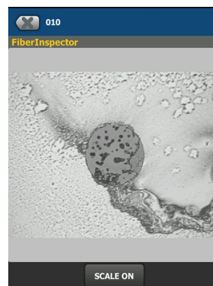
Les solvants spécialisés (à gauche) sont beaucoup plus efficaces pour le nettoyage des extrémités que l'alcool isopropylique, qui peut laisser un résidu (à droite).
