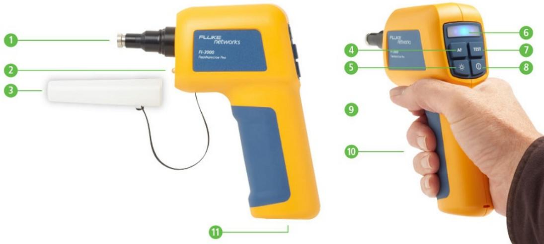
1. Des embouts interchangeables prennent en charge une ou deux rangées de 8, 12, 16 ou des connecteurs uniques UPC ou APC
