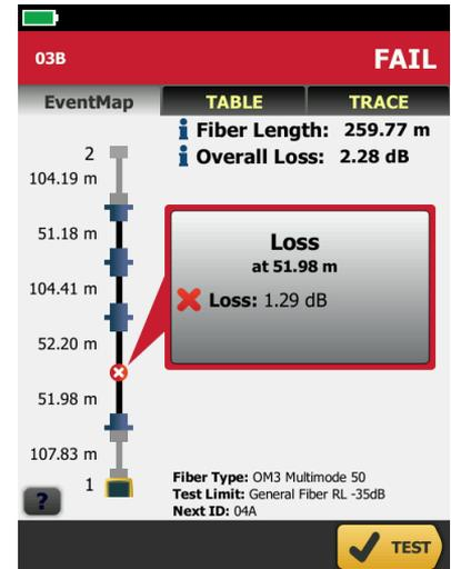
Les tests de diagnostic plus avancés vous diront exactement ce qui doit être réparé
