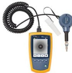
Figure 2b : Ecran et sonde FI-500 FiberInspector™ Micro de Fluke Networks.
