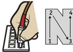
Figure 8 : « Humide à sec » : méthodologie de nettoyage à l'aide d'une carte de nettoyage optique de Fluke Networks. La goutte de solvant est placée sur « 1 », et la face de l'extrémité se déplace à travers le matériel de nettoyage de « 1 » vers « 4 »
